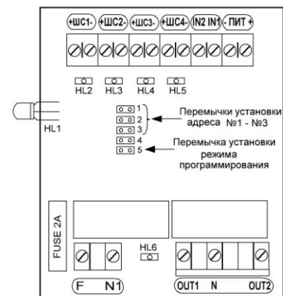
Рис.3 - Расположение индикаторов и перемычек на плате БКК
