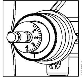
2 Отверстие для дифференциального регулятора давления связано с портом В
