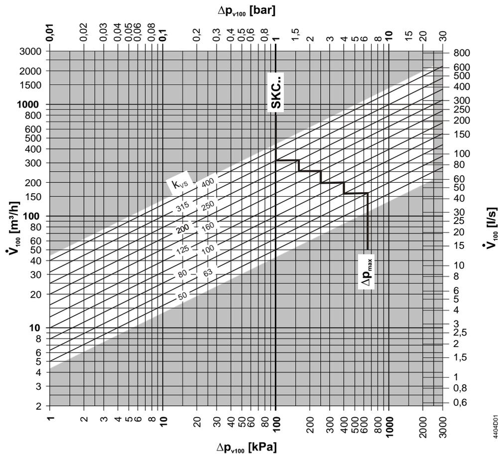
$\Delta p_{max}$  значения применяются для случая использования клапана в качестве смесительного.
