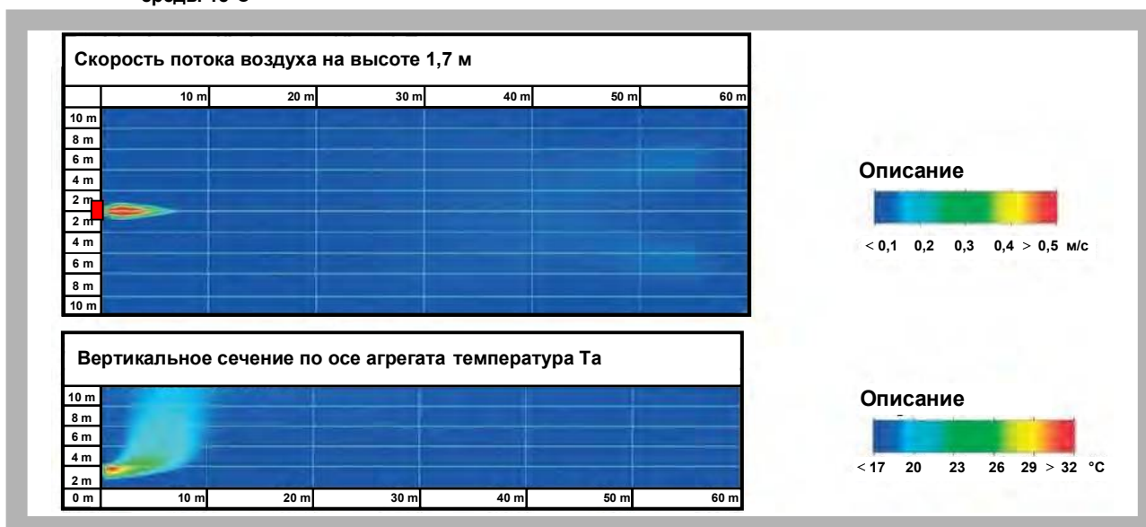
Рис. 13. Воздухонагреватель MONZUN 130. Макс. расход воздуха, положение жалюзи - 45°, температура окружающей среды 18°C
