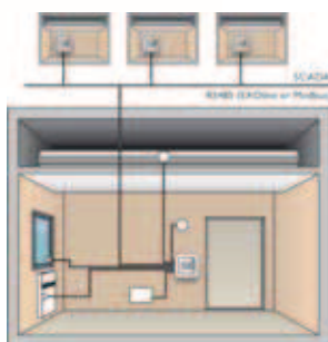
Regio Midi: предварительно запрограммированные комнатные контроллеры с сетевым интерфейсом.
