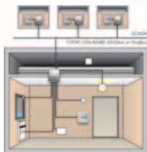
Regio Maxi: свободно программируемые контроллеры с поддержкой сетевых протоколов и веб-интерфейсом.
