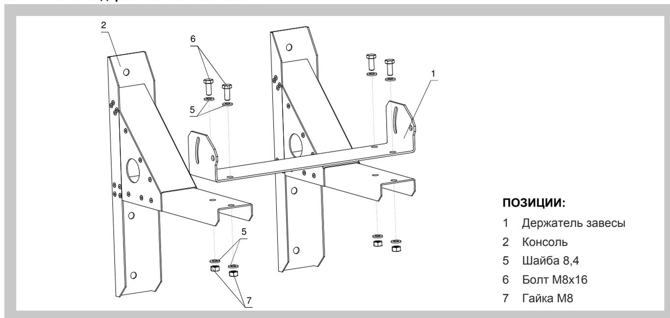
Рис. 11. Монтаж воротной завесы на держатель
