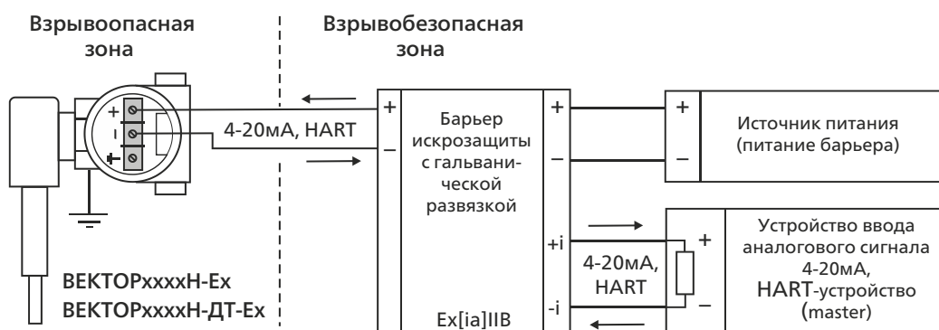
РИСУНОК 26. Схема подключения уровнемеров ВЕКТОРXXXXН-Ex, ВЕКТОРXXXXН-ДТ-Ex с применением барьера искрозащиты, имеющего гальваническую развязку искробезопасных цепей и цепей питания.
